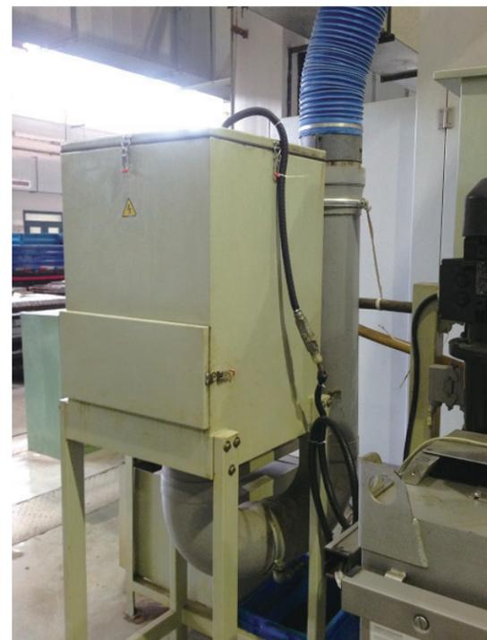
机床上更新的油雾净化装置
