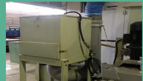
机床上更新的油雾净化装置
