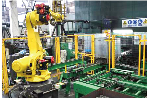
存在化学因素职业危害的滴漆岗位采用机器人替代人工操作
