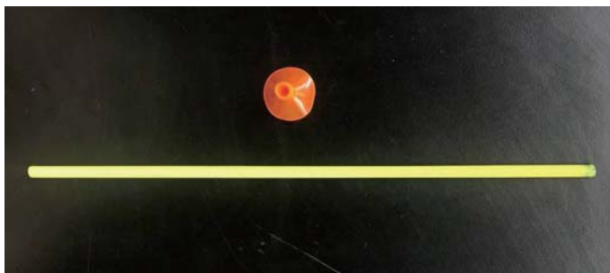
保护端部吸盘脱落, 分离部件(杆)能从预定弹射机构中发射。
