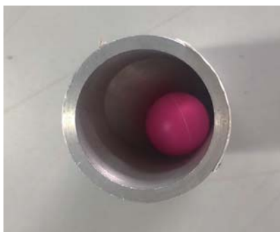
图2 不合格项示例：球形弹射物可完全置入小零件试验器
